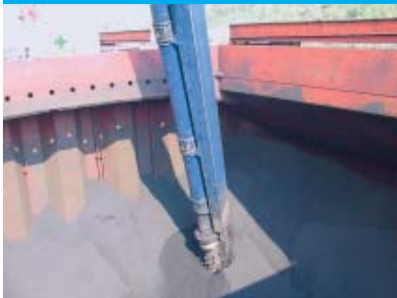
Uređaj koji ugljen iz štiva velikoga broda prebacuje u sustav za dopremu ugljena od luke do elektrane
