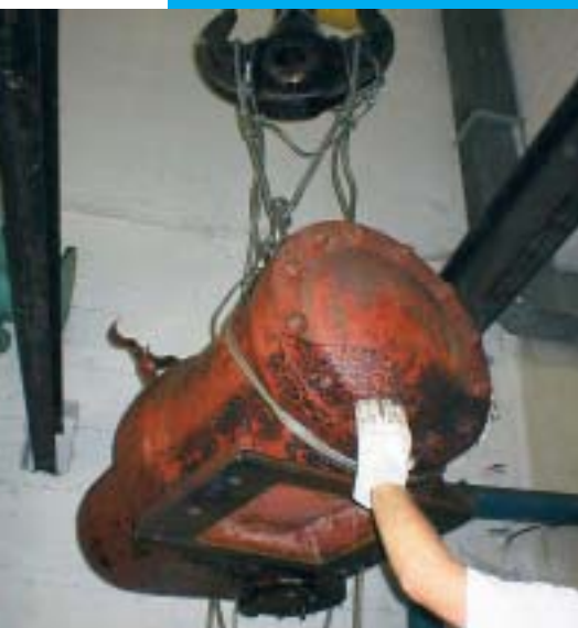
...i njegova otprema u tvornicu na reviziju i prilagodbu na viši tlak uljnog dijela hidraulike
