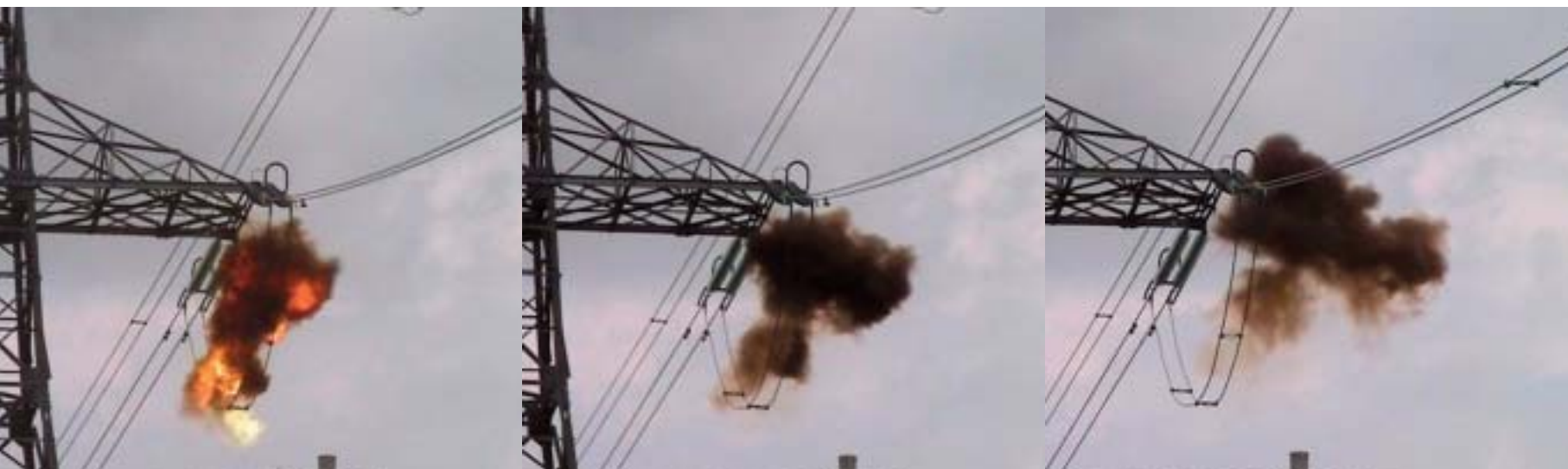
Na DV 220 kV za Cirkovce napravljena je dopunska konstrukcija sa dva kompozitna izolatora u okomitom položaju kako bi se pri kratkom spoju izazvao luk po izolatoru, a ne po zračnom rasporu (zraku) kao pri ostalim kratkim spojevima
