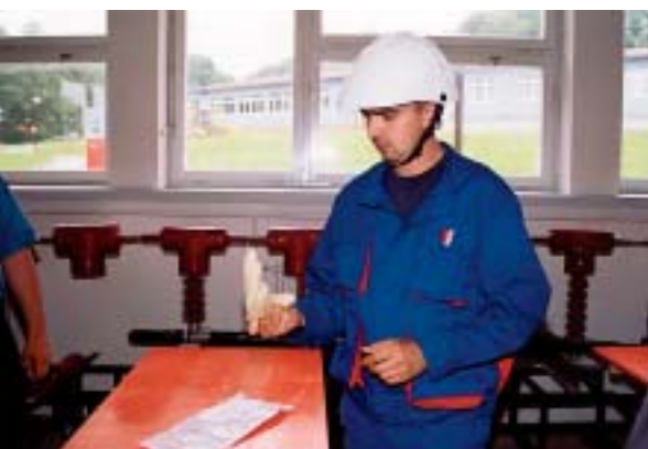
Prije početka rada pod naponom Vinko Topić najprije provjerava ispravnost gumenih rukavica, jer iznimno je važna dobra primjena svih osobnih zaštitnih sredstava, s čime započinje siguran rad pod naponom
