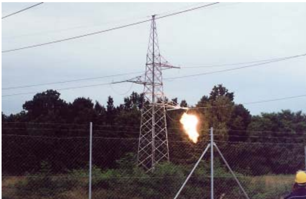
Na DV 220 kV za Cirkovce napravljena je dopunska konstrukcija sa dva kompozitna izolatora u okomitom položaju kako bi se pri kratkom spoju izazvao luk po izolatoru, a ne po zračnom rasporu (zraku) kao pri ostalim kratkim spojevima
