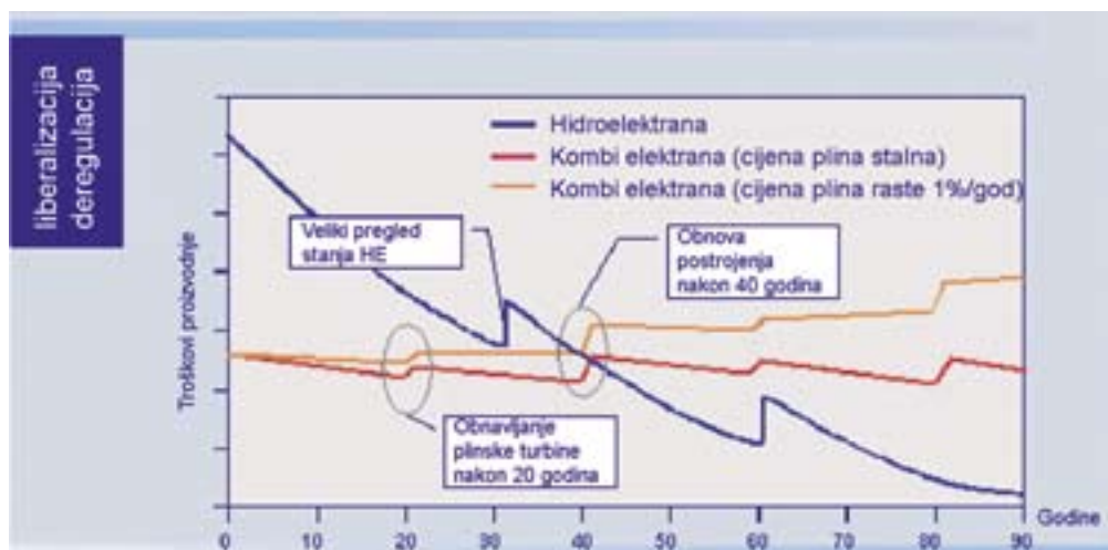
Slika 10: Usporedba troškova proizvodnje hidroelektrane i kombi elektrane
