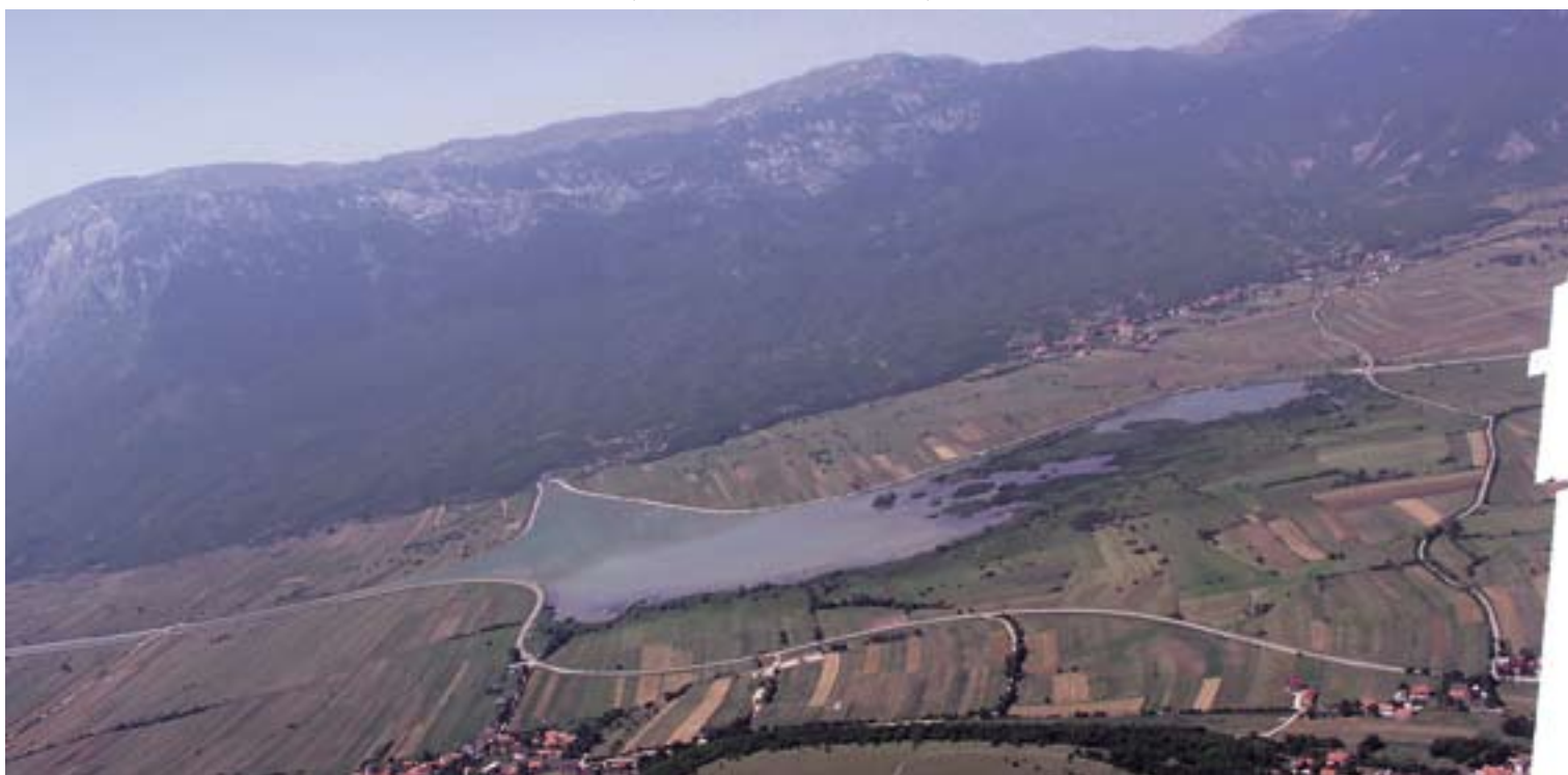
Livanjsko polje, ovog puta iz ptičje perspektive, gdje se prikupljeni dotoci mrežom kanala dovode do kompenzacijskog bazena Lipa, iz kojeg kroz dovodni tlačni tunel i čelični tlačni cjevovod odlaze na turbine HE Orlovac
