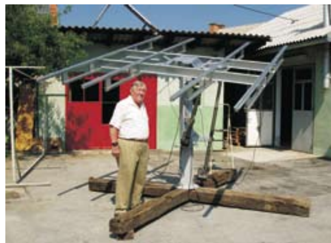
Roko Vincetić u tijeku ispitivanja uređaja za praćenje Sunca
