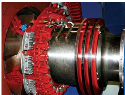
...uvodi se novi beskontaktni način mjerenja i prijenoša podataka, kompleksniji i bolji, koji ne onečišćuje rotor grafitnim česticama, odnosno ne smanjuje njegovu izolaciju
