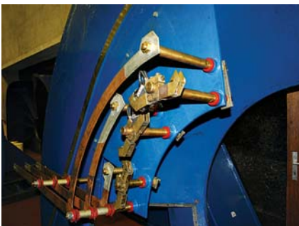
Jedinstveno inovacijsko rješenje, umjesto starog načina mjerenja i signala s rotora na stator grafitinim česticama...
