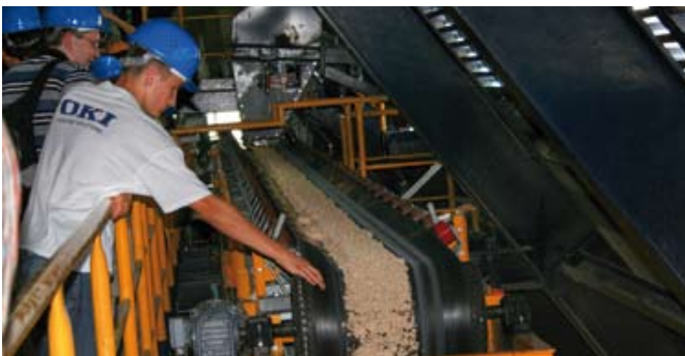
Između ostaloga, učenici su bili u prigodi vidjeti kako nastaje gips kao nusproizvod koji se, zajedno s ostalim nusproizvodima poput šljake i pepela, transportira u cementaru na daljnju preradu
