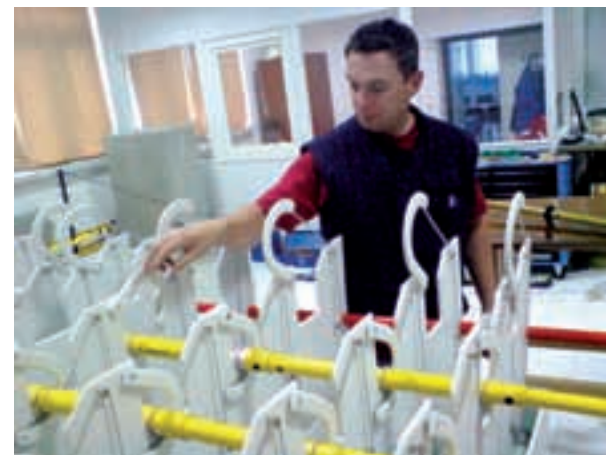
Z. Jogun postavlja izolacijske motke u položaj za ispitivanje s 90 kV
