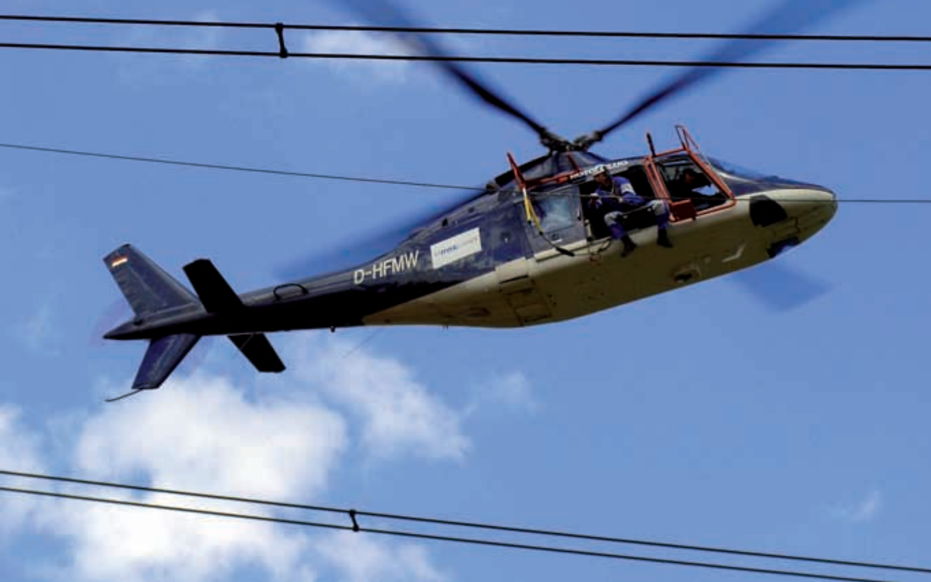
Posebno impresivni bili su pokazni praktični radovi pod naponom: popravak zemnog užeta na lutajućem potencijalu – RWE, Njemačka....
