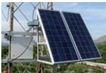
Uređaj za snimanje amplitude i oblika struje groma na stupu 38 DV 110 kV Ston - Komolac
