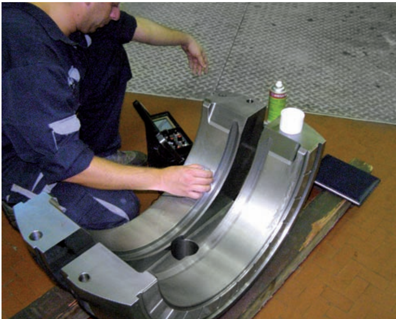
...te NDT ispitivanja ležajeva agregata ultrazvukom
