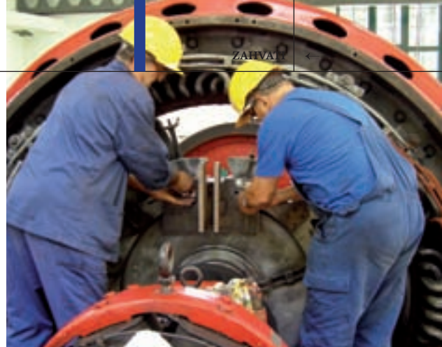
Nakon uspješno provedenog zahvata, Josip Lisac i Branko Vrbanac demontiraju hidrauličku pripremu
