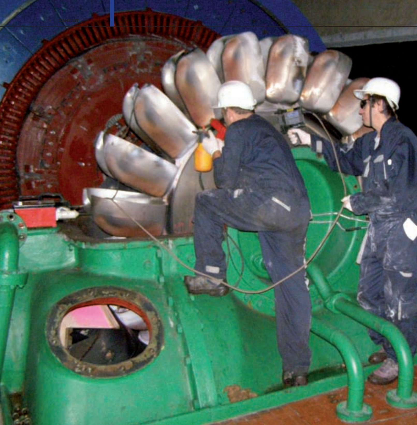
Ispitivači Odsjeka za čelične konstrukcije IGH izvode NDT ispitivanja radnih kola turbina magnetofluksom...
