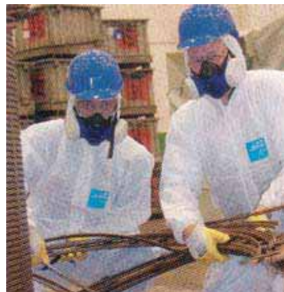
Envio AG. Envio Recycling GmbH & Co. KG jedno je od rijetkih poduzeća koje ispire PCB iz starih transformatora i koje može takvu opremu oporabiti (detalj iz pogona)
