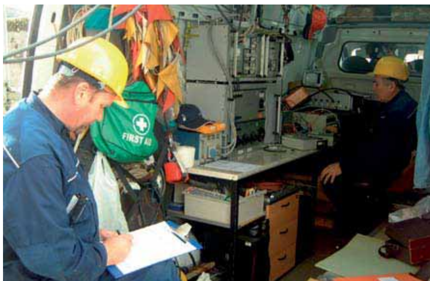
Električka ispitivanja blok transformatora A obavili su stručnjaci Instituta za elektroprivredu i energetiku iz Zagreba
