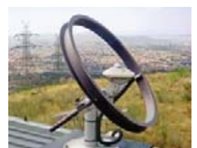
Piranometar sa sjenilom (prstenom) - mjerenje raspršenog Sunčeva zračenja
