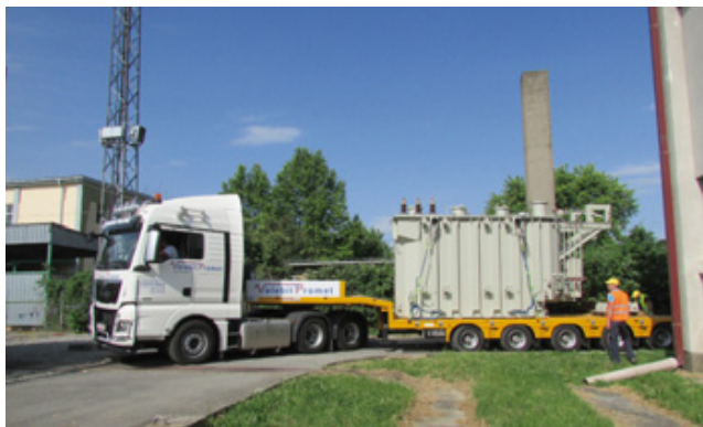
Prijevoz na kamionu - labudici, na kojoj se prevozi teret izvan gabarita
