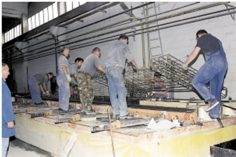
Izrada armaturnih koševa za AB stupove
