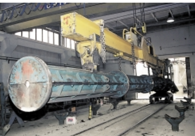
Svakih petnaest minuta ide novi stup na centrifugiranje, a u jednoj se smjeni proizvede između 28 i 30 stupova
