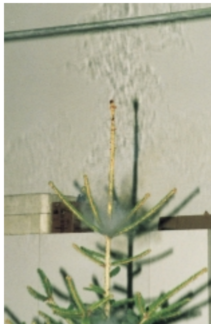
Tri požarna stupa i ponašanje raspona "energizirani vodič-živo stablo": ... stupac dima (nema preskoka)...
