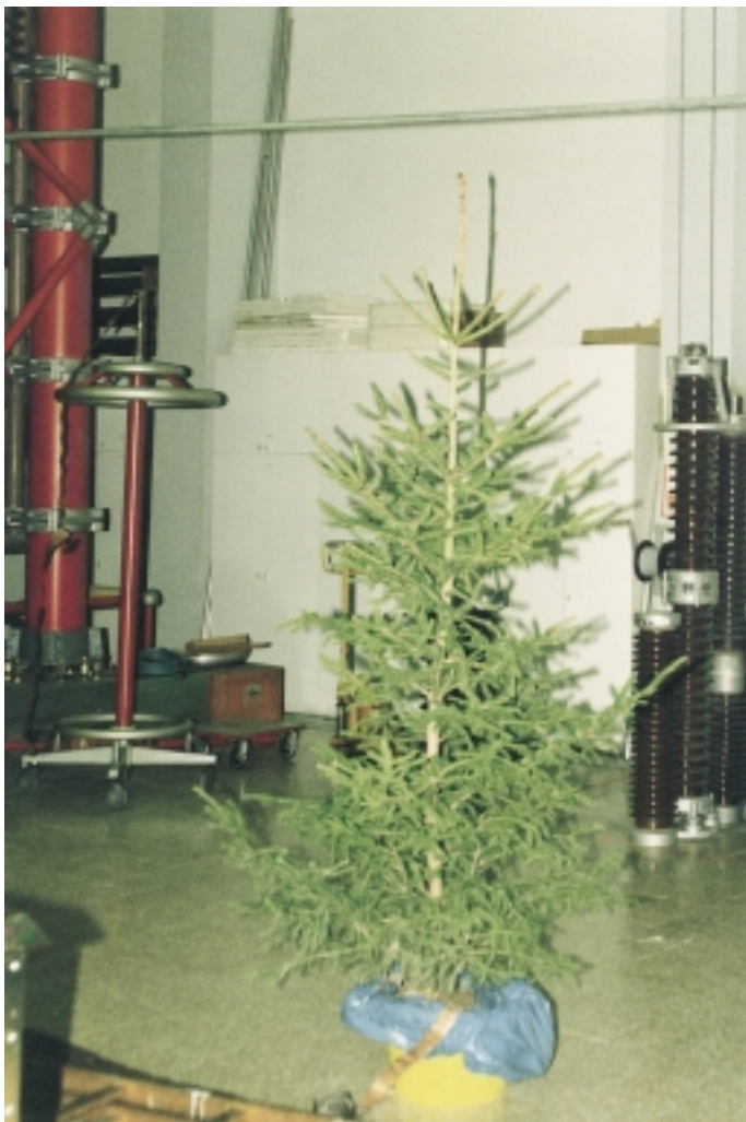
Živo stablo u visokonaponskom laboratoriju Instituta za elektroprivredu - osnovna ispitna konfiguracija: stablo, vodič pod naponom (iznad stabla) i generator
