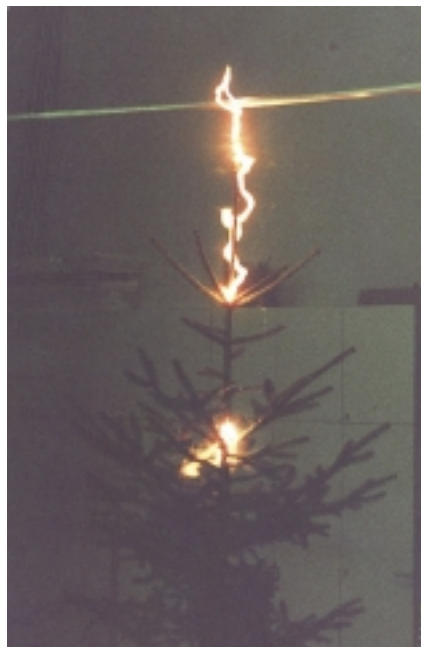
Tri požarna stupa i ponašanje raspona "energizirani vodič-živo stablo": ... stupac dima (nema preskoka)...
