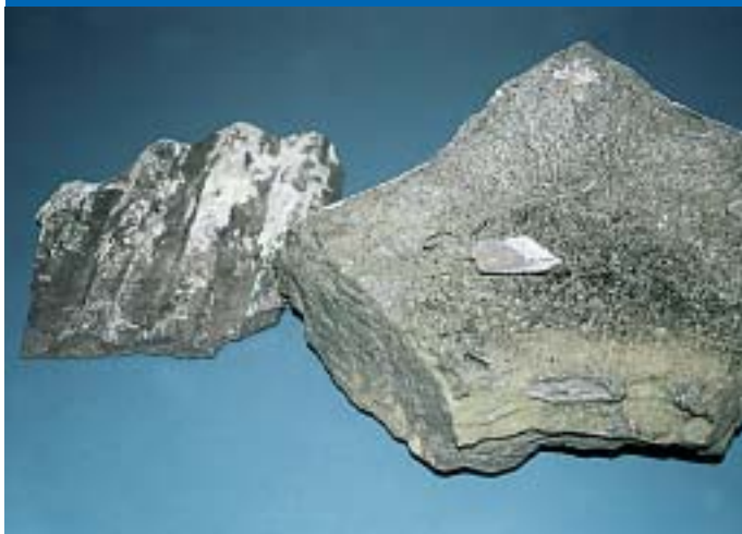
Izgleda nevjerovatno da od tekućeg energenta u ložištu ostaju ovakvi grumenovi taloga kojeg valja redovito čistiti i zbrinjavati kao otpad
