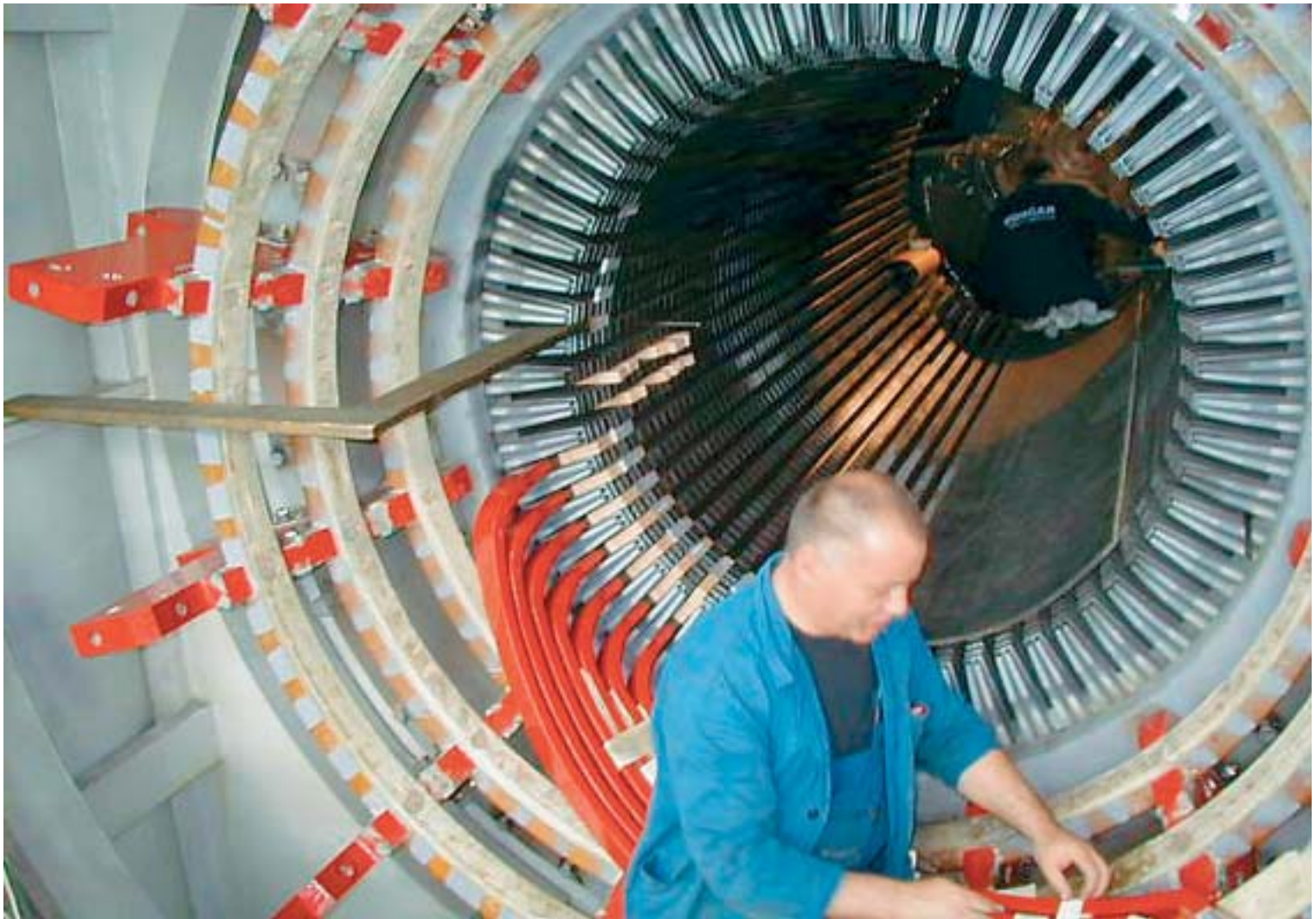
Ovako izgleda novi namotaj statora
