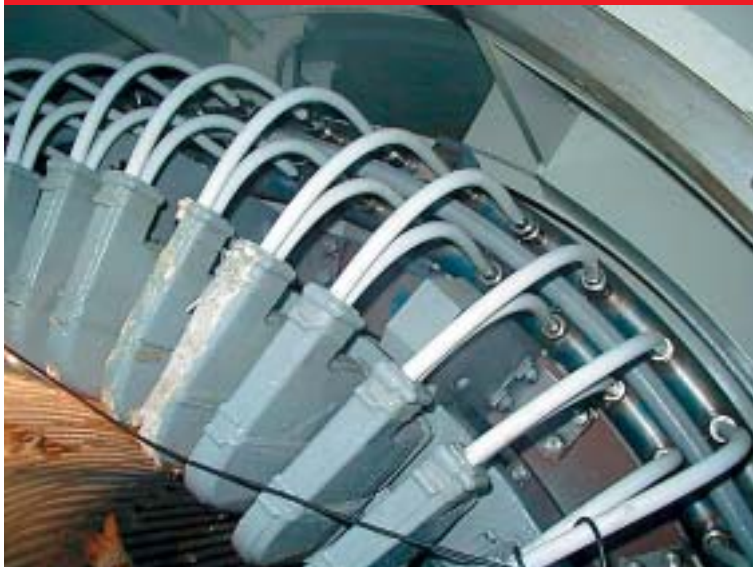
Stari namotaj statora generatora hlađen vodom
