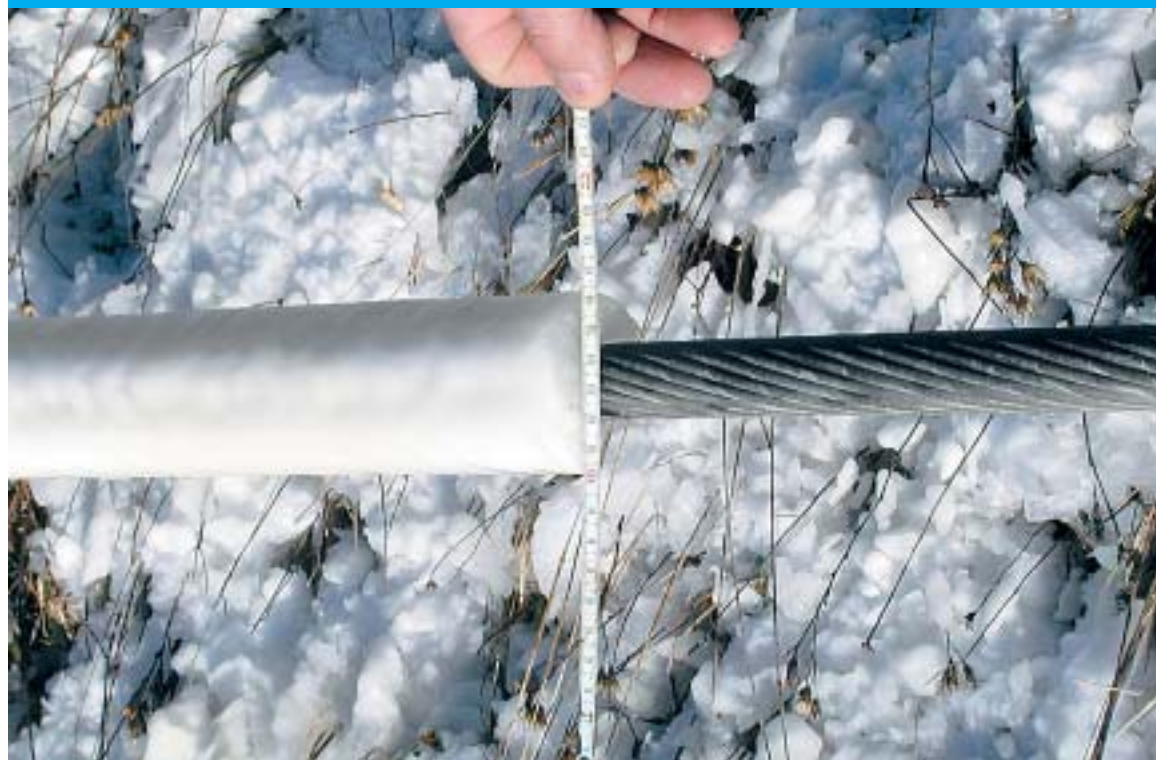
Interventna ekipa Odsjeka za održavanje dalekovoda PrP Opatija pregledava oštećene dalekovodne stupove pokraj Triblja te mjeri naslage leda na vodičima
