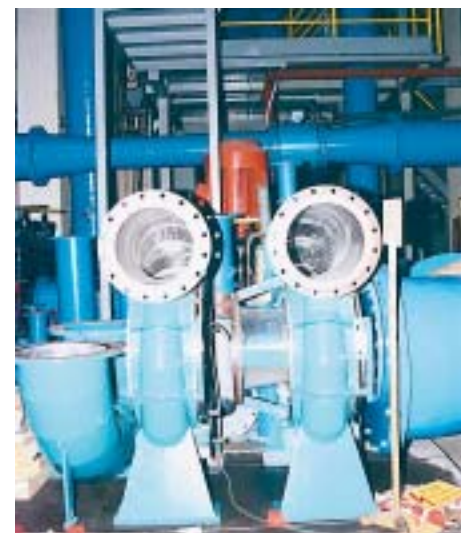
Na ispitnoj stanici za Francis turbine demontira se model za HE Preuča i priprema teren modelu za HE Dubrovnik
