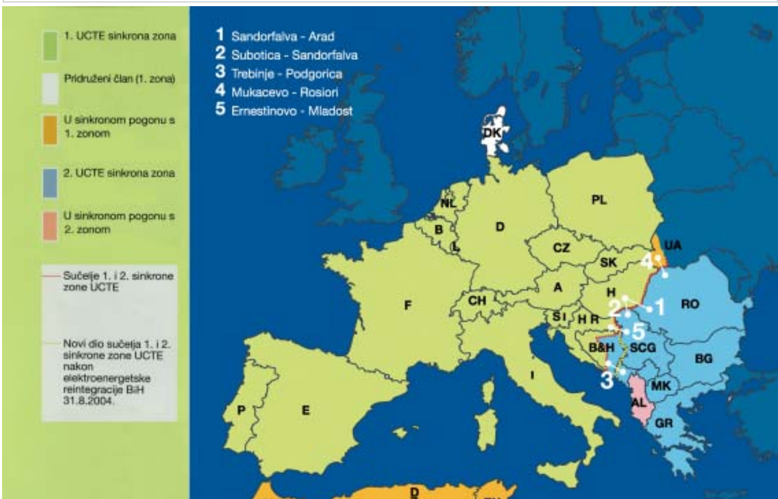
Sučelje povezivanja s glavnim 400 kV vodovima
