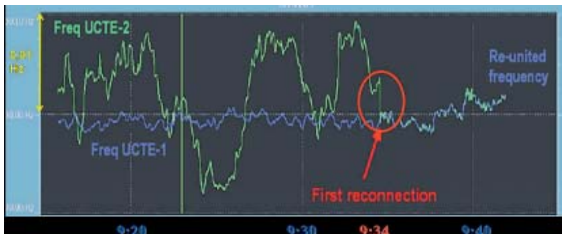
Dvije zone stopile su se u jednu (prikaz frekvencije, ETRANS zapis s Wide-Area Protection System Guard, 10. listopada 2004.)
