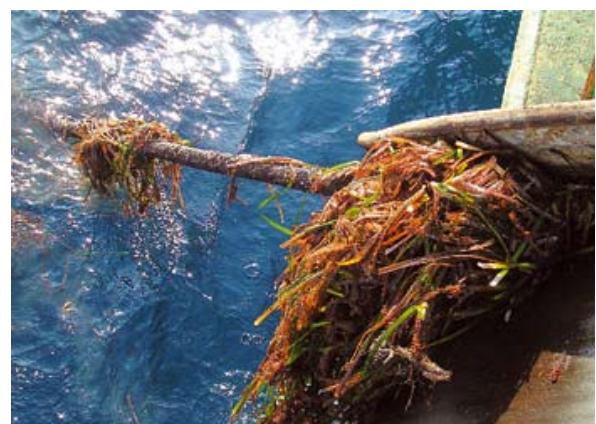
Alge na jednom od izvađenih kabela
