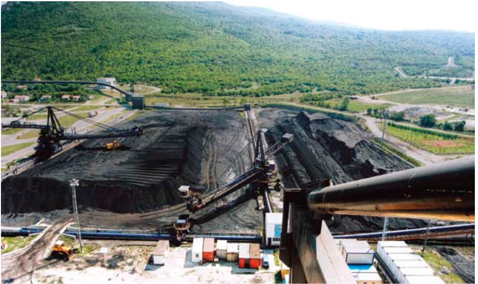
Na deponiju je trenutno golemo brdo ugljena, približno 92.000 tone, što postrojenja TE Plomin 1 i TE Plomin 2 progutaju za mjesec dana
