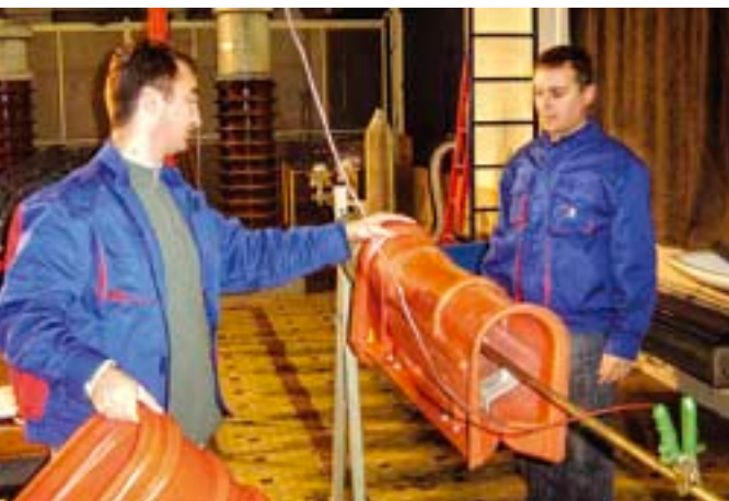
Priprema ispitivanja izolacijske prekrivke za SN vodiče
