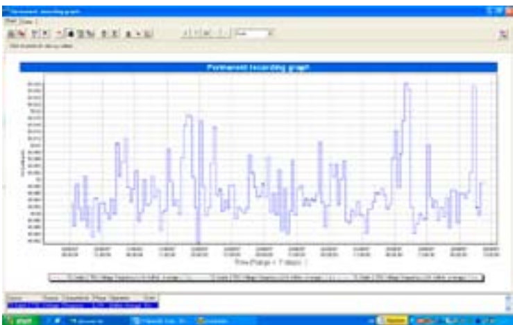
Snimak frekvencije na 35 kV strani TS 110/35 kV Osijek 2
