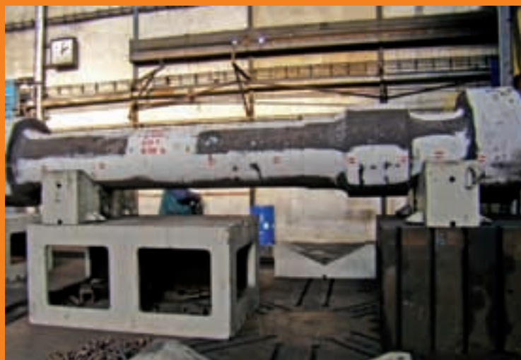
Odljevnik vitla za glavne turbine teži 18. 500 kilograma
