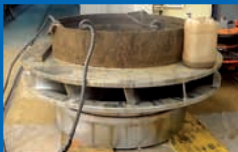
Najveća oštećenja su na demontiranom radnom kolu gdje je, osim kavitacije na ulaznim i izlaznim bridovima lopatica, vidljiv i potpuno zahrđali gornji labirintni prsten
