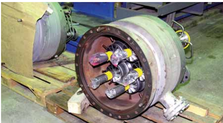
Novi dijelovi komora izgaranja plinskih turbina čekaju ugradnju
