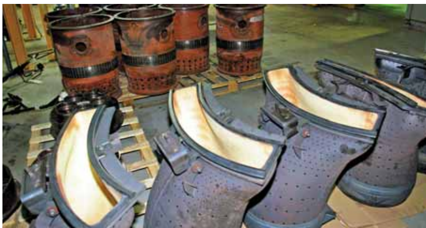
Dijelovi izvadeni iz plinskih turbina bit će upućeni u najbliži servis General Electrica u Madarskoj, gdje će biti obnovljeni i ponovno će se ugraditi sljedeće godine
