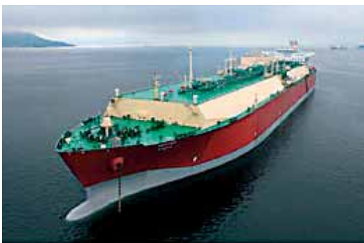
Slika 13. Premda je za 80 posto veći od konvencionalnih brodova, Mozah u odnosu na njih ima za 20 posto manji jedinični trošak transporta LNG-a
