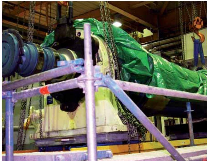
Remont plinskih turbina podrazumijeva i remont pripadajućeg električnog generatora
