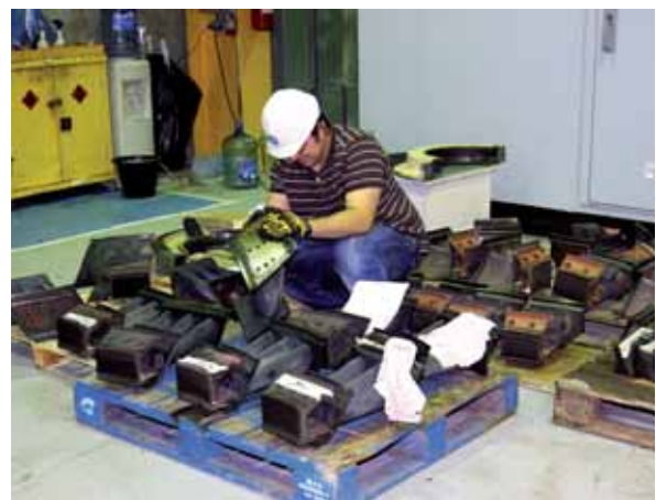
Stručnjak General Electrica pregledava izvadene turbinske statorske lopatice
