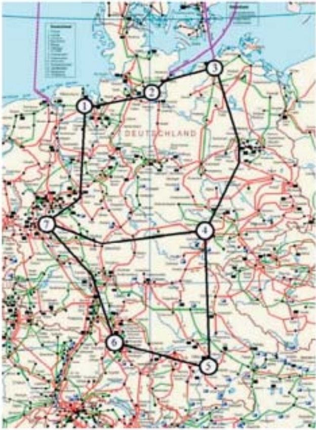
Shematski prikazano uklapanje krovne mreže u postojeću mrežu
