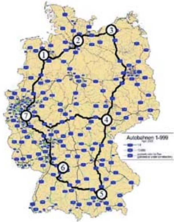
Moguće polaganje tunela duž vrlo visokog napona moguće izabranih postojećih autoputova u Njemačkoj (najdulji potez 3-4 dug je skoro 500 kilometara; u čvorišta 1 do 3 utiskivala bi se energija, a u ostalim čvorištima oduzimala bi se energija, u normalnom pogonu krovne mreže)
