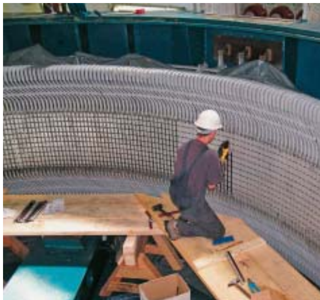
Rasklinjavanje statorskog namota
