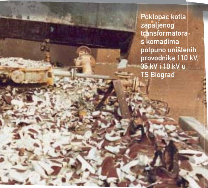
Temeljito oštećeni 110/45 kV transformator u TS 110/35/10 kV Biograd
