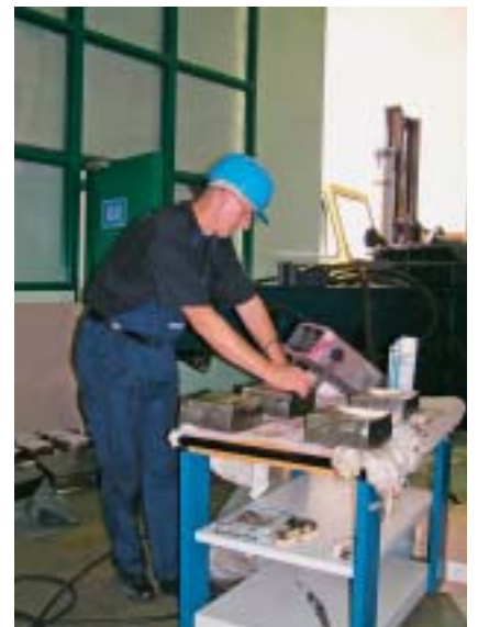
Ispitivanje segmenata ležajeva NDT ultrazvučnom metodom
