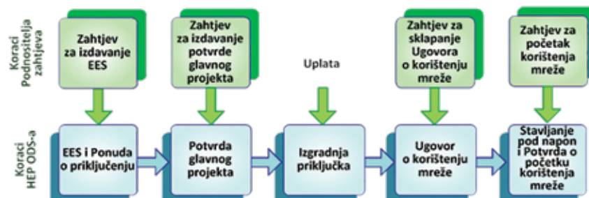
↑ Slika 2: Koraci u postupku jednostavnog priključenja ako u EES nije uvjetovan pokusni rad
