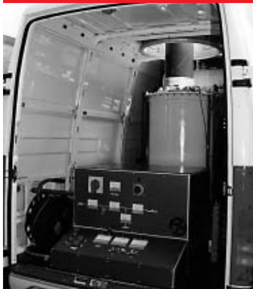
Radovi su počeli - srce ispitne stanice predstavlja visokonaponski ispitni transformator (250 V/200 000 V, snaga 50 kVA)
