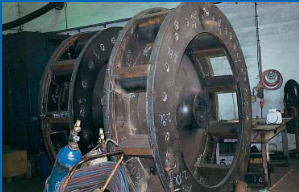
Generator turbine prije remonta - izvlačenje rotora
