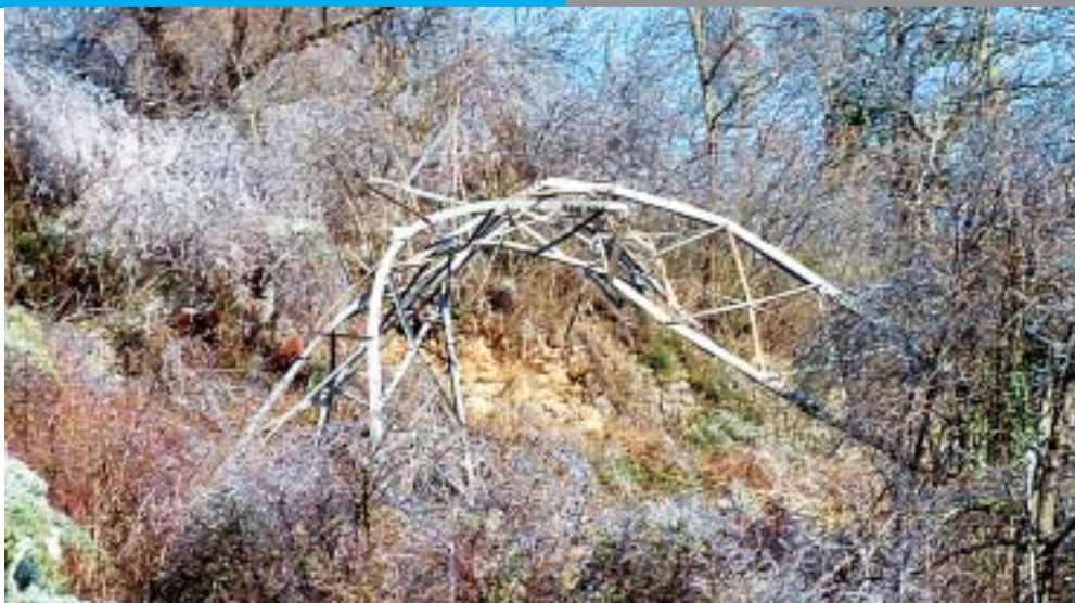
Ono što je ostalo od čelično-rešetkastog stupa
