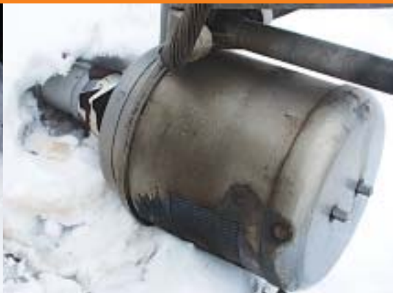
Dijelovi komore prekidača razbacani su nekoliko desetaka metara uokolo
