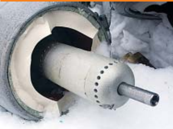
Dijelovi komore prekidača razbacani su nekoliko desetaka metara uokolo
