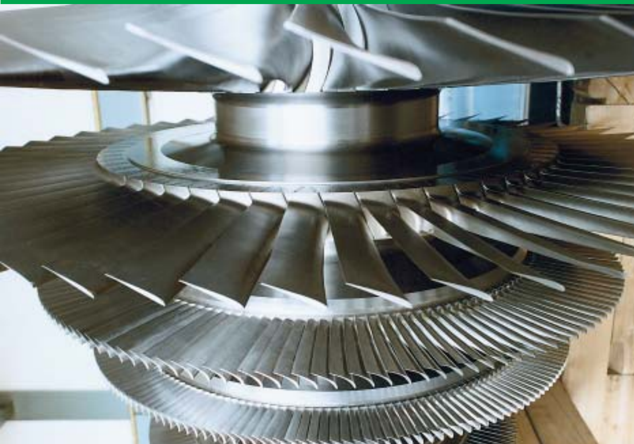
Rotor parne turbine (niski tlak)
