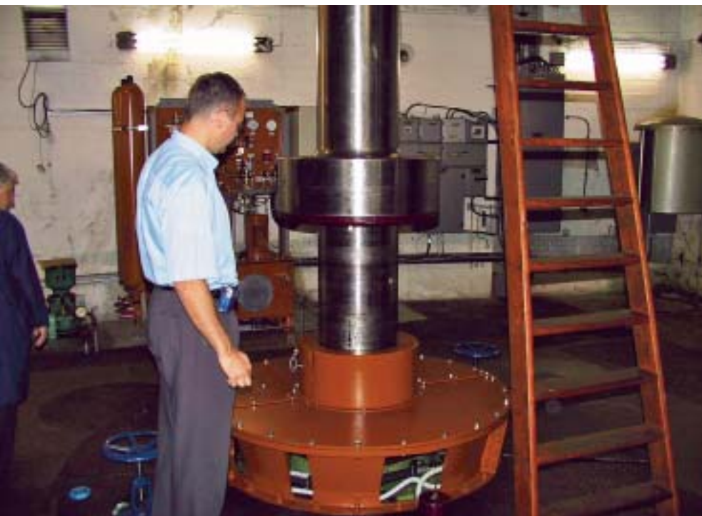
Direktor Boris Glavan i tehnički rukovoditelj Josip Dragičević ispred rekonstruiranog ležajnog sklopa i dijela sustava turbinske regulacije agregata 2...
