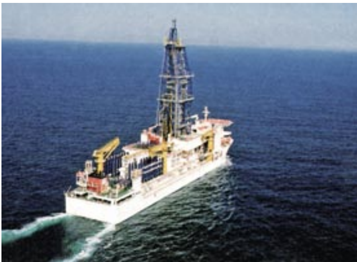
Japanski istraživački brod "Chikyu" posjeduje posebnu opremu za bušenja plinskog hidrata
