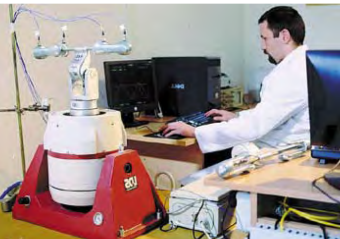
Ispitivanja prigušivača vibracija, rastojnika i rastojnika prigušivača
