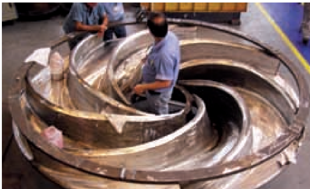
Međufazna defektoskopska kontrola zavara između lopatica i doljnjeg vijenca rotora u tvornici koncerna Voith-Siemens Hydro Power Generation u Sao Paolu
