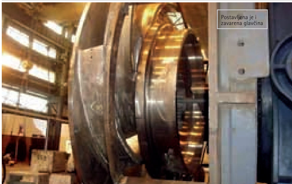
Međufazna defektoskopska kontrola zavara između lopatica i doljnjeg vijenca rotora u tvornici koncerna Voith-Siemens Hydro Power Generation u Sao Paolu
