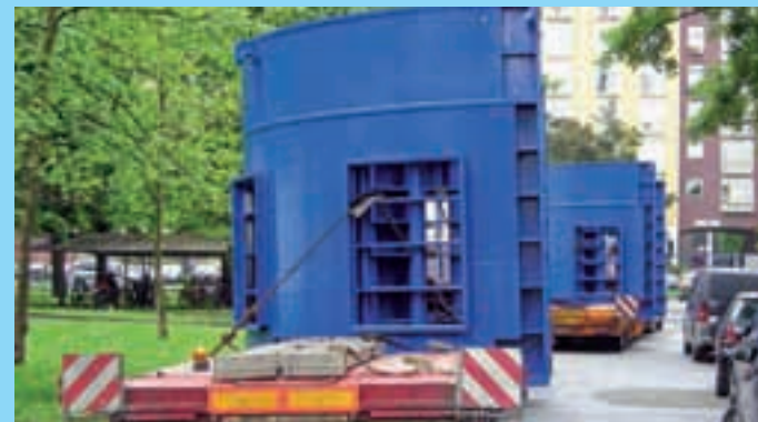
Labudice odvoze kućište generatora A HE Zakučac iz tvornice Končar - Generatori i motori u Zagrebu
