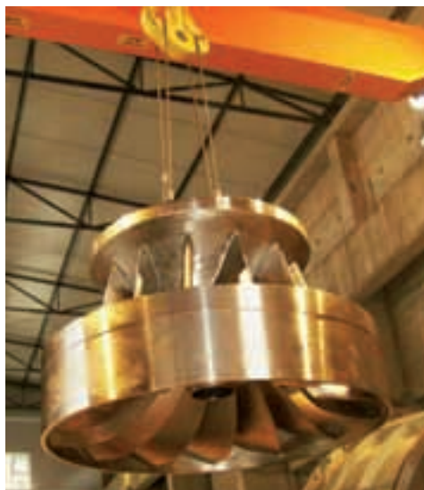
Montaža radnog kola turbine A, mase 11,5 tona - u zraku...
