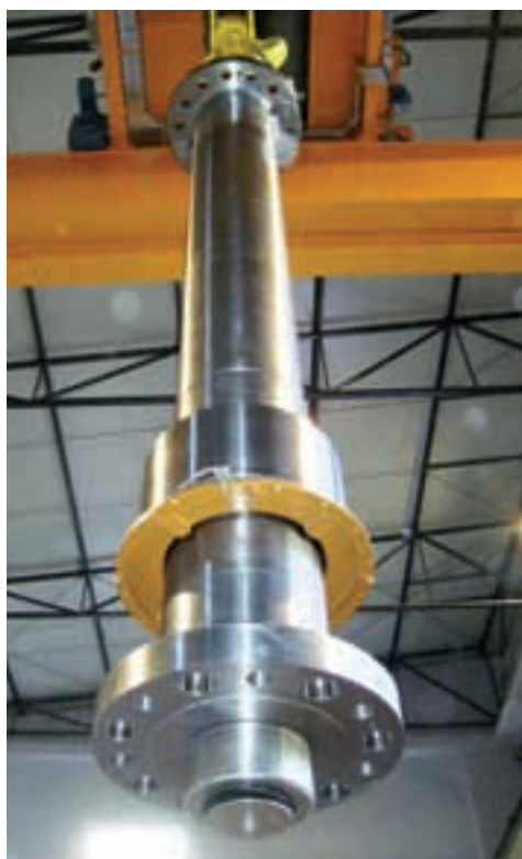
Montaža turbinskog vratila A, mase 10,16 tona - u zraku...
