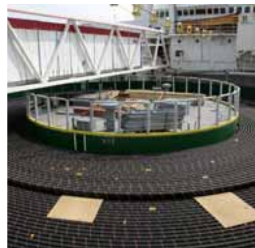
HVDC kabel za podmorsko polaganje (izvor: www.britned.com )
