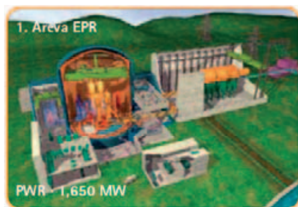
Nuklearni reaktori Areva - PWR 1 650 MW i BWR 1 100 MW
