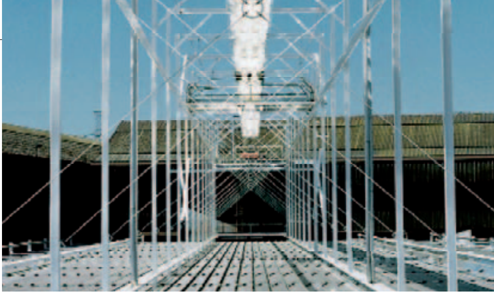
Sabirni frensel sustav postrojenja Sunčeve termoelektrane može biti širok do 24 metra i do jedan kilometar dug
