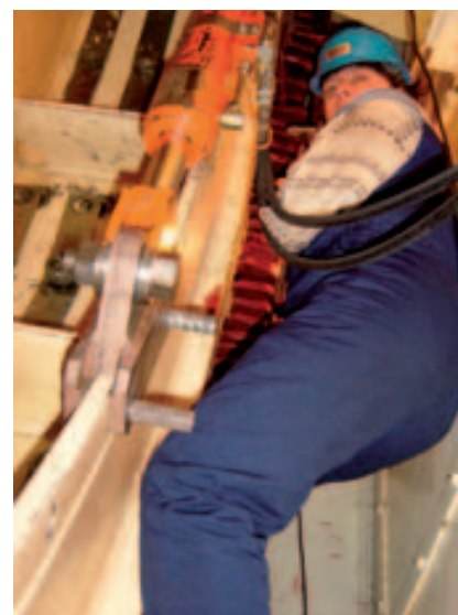
Bump test - ispitivanje zaklinjenosti statora generatora A
