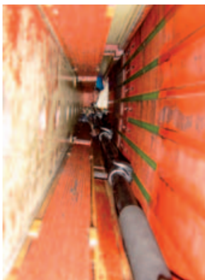
Bump test - ispitivanje zaklinjenosti statora generatora A
