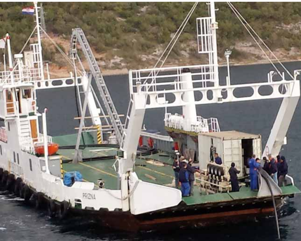
Nakon temeljitih dvotjednih priprema, kabel Krk-Cres položen je uz pomoć trajekta Prizna riječke Jadrolinije tijekom samo jednog dana
