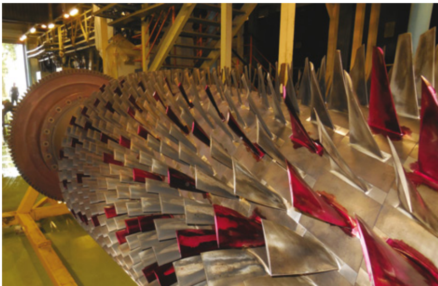
Vizualnim pregledom utvrđeno je tehnički ispravno stanje vitalnih dijelova rotora turbine. NDT kontrolom nađene su sitne indikacije (F.O.D.) na listovima dvije kompresorske lopatice, koje su ručno otklonjene
