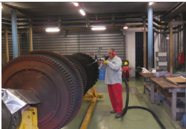
Čišćenje rotora "suhim ledom", vizualna i NDT kontrola: postojeće olopaticenje oba stupnja zamijenjeno je novim
